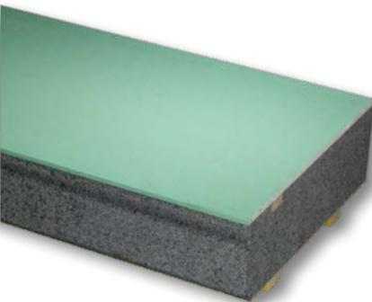
Panneau sandwich porteur et isolant constitué d'une sous-face en plaque de plâtre hydrofugée d'épaisseur 12,5 mm faisant office de parement plafond, d'une âme isolante en polystyrène expansé gris, d'un parement supérieur en bois hydrofugé d'épaisseur 3 mm et de deux contre-lattes de section 24 x 47 mm en bois résineux de couleur rouge.
