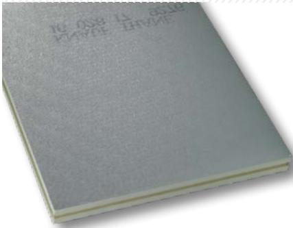
Panneau isolant composé d'une âme en mousse rigide de polyuréthane de type PIR et de deux parements en aluminium gaufré 50 µm, destiné à l'isolation thermique des murs par l'extérieur sous bardage ventilé. Bâtiments d'habitation de 1<sup>ère</sup> et 2<sup>ème</sup> familles, ERP du 1<sup>er</sup> et 2<sup>ème</sup> groupes, et autres bâtiments tertiaires (hors IGH).
