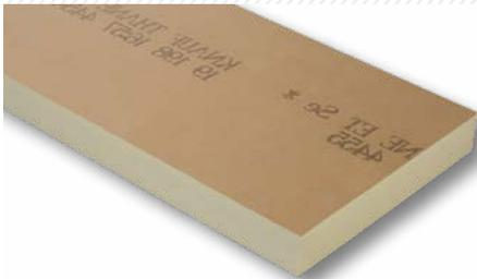
Panneau composé d'une âme en mousse de polyuréthane de type PIR et de deux parements composites kraft, destiné à l'isolation thermique des toitures-terrasses sous protection lourde.
