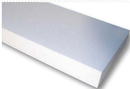
Panneau en polystyrène expansé blanc ignifugé, destiné à l'isolation des soubassements et murs enterrés jusqu'à 2,40 m de profondeur d'enfouissement. Les parties enterrées visées sont de catégories 2 et 3.
