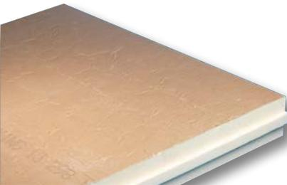
Panneau isolant composé d'une âme en mousse de polyuréthane de type PIR et de deux parements de surfaces multicouches composites anti-glisse quadrillés, destiné à l'isolation des toitures par l'extérieur. Les bords rainurés bouvetés 4 côtés (RB4).
