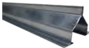
PROFILÉ AUTO-PORTANT OMÉGA Profilé en acier galvanisé Longueurs : 1200, 1800 ou 2400 mm
