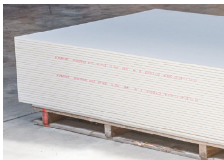
Plaques Knauf HydroProof® sur chantier
