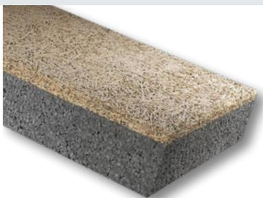
Panneau isolant composite de laine de bois constitué d'une âme en PSE gris et d'un parement de 20 mm en fibres longues de bois résineux sélectionnés, minéralisées et enrobées de ciment blanc. Le parement de 20 mm est chanfreiné sur 4 côtés.
