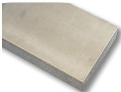
Panneau composite constitué d'un isolant en polystyrène expansé gris à bords feuillurés et d'un parement en panneau de particules liées au ciment à bords biseautés. Il est destiné à l'isolation par l'extérieur des murs de soubassement.
